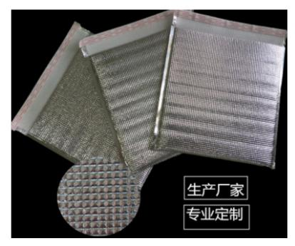
杭州鑫发现生产铝膜珍珠棉,铝膜珍珠棉由铝膜和珍珠棉经特定的机器复合而成,按结构可以分为单层铝膜和双面铝膜,双面复铝膜的珍珠棉隔热效果要远远高于单面的,因为在热传递的过程中是双向的交互的,一方传递热能、一方吸收热能,双面复铝膜的珍珠棉在热量的隔绝上减慢了传递与吸收。当然,珍珠棉双面复铝膜的成本也是相对来说较高的,故而价格也比单面铝膜材料要贵,所以一般只用于保温隔热要求较高的产品或者有特殊要求的出口客户。铝膜复合珍珠棉产品也可以定制不同纹路、可定制印刷,也能定制不同尺寸。杭州鑫发现,源头工厂,品质有保证。
